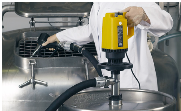
Fasspumpe zur Förderung von entzündbaren Flüssigkeiten.
