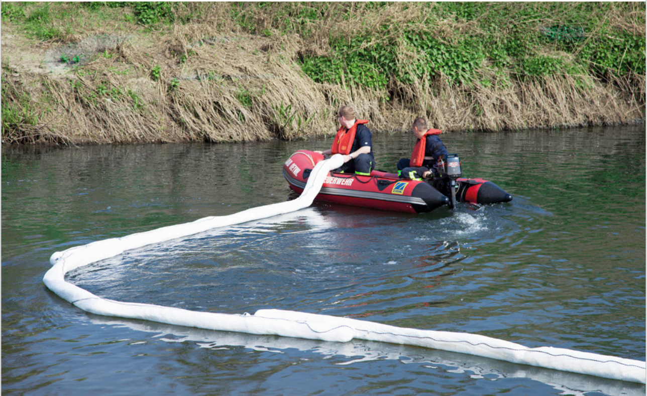
DENSORB Ölsperren (hier: 6-m-Segmente) zum Eindämmen und Aufnehmen von Ölverschmutzungen auf Wasseroberflächen
