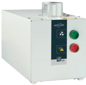
Entlüftungsaufsatz zur Montage auf dem Schrank, für Hochschränke, mit Abluftüberwachung, CE konform: \text{CE} \text{ II } 3\text{-G Ex ic nA IIB T4 Gc} , explosionsgeschützt, Absaugung aus: EX-Zone 2 / Aufstellung: außerhalb EX-Zone Bestell-Nr. 14220
