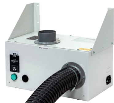
Entlüftungsmodule zur Wandmontage, CE konform: \text{CE} \text{ II } 3\text{-G Ex ic nA IIB T4 Gc} , explosionsgeschützt, Absaugung aus: EX-Zone 2 / Aufstellung: außerhalb EX-Zone Bestell-Nr. 17178
