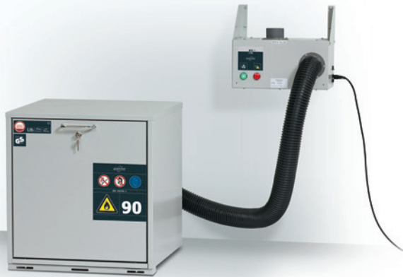
Entlüftungsmodule zur Wandmontage, für Unterschränke, mit Abluftüberwachung, CE konform: \text{CE} \text{ II } 3\text{-G Ex ic nA IIB T4 Gc} , explosionsgeschützt, Absaugung aus: EX-Zone 2 / Aufstellung: außerhalb EX-Zone Bestell-Nr. 24315
