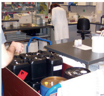
Falsche Lagerung von Gefahrstoffen ...
