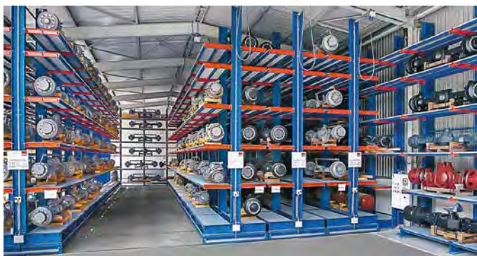
Verschieberegalanlage Steigerung der Lagerkapazität um 110% = 21 Regalzeilen
