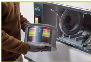
1 Gerät auspacken, Gehäusefront öffnen und Filter entnehmen
