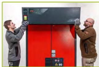
2 Aufsetzen des Umluftmoduls auf den Schrank und Verbindung zur Schrankentlüftung herstellen
